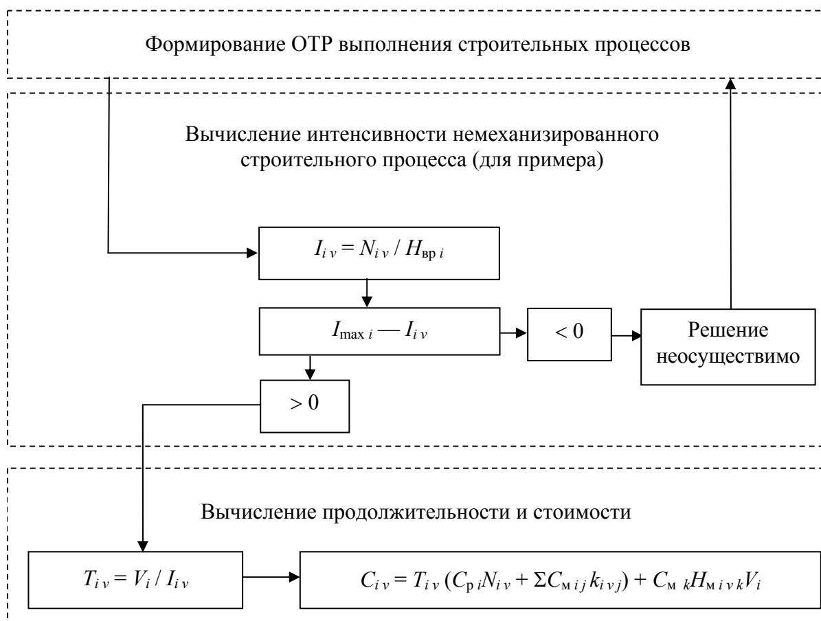
Рис. 1.2. Пример логико-арифмитического описания решения задачи для последующей разработки программы: I_{iv} — интенсивность i -го строительного процесса для v -го варианта его выполнения; N_{iv} — количество рабочих, участвующих в процессе; H_{вpi} — норма затрат рабочего времени; I_{max i} — ограничения по интенсивности выполнения процесса (например, максимальная интенсивность доставки материальных ресурсов); T_i — продолжительность выполнения i -го строительного процесса для v -го варианта его выполнения; V_i — объем работ для i -го строительного процесса; C_{iv} — величина прямых расходов для i -го строительного процесса для v -го варианта его выполнения; C_{pi} — повременная расценка стоимости чел.-ч; C_{mij} — повременная расценка стоимости маш.-ч для j -й строительной машины; k_{jiv} — количество строительных машин j -го типа, участвующих в i -м строительном процессе для v -го варианта его выполнения; C_{mk} — стоимость k -го строительного материала; H_{mivk} — норма расхода k -го материала в i -м строительном процессе для v -го варианта его выполнения
